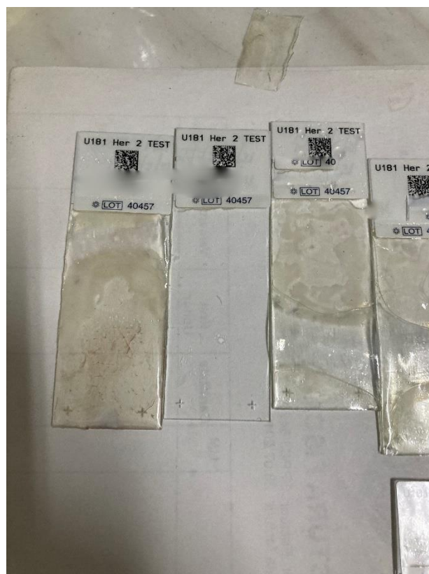
Figura 16. Detașare parțială sau completă a peliculei active sau a peliculei de protecție.
